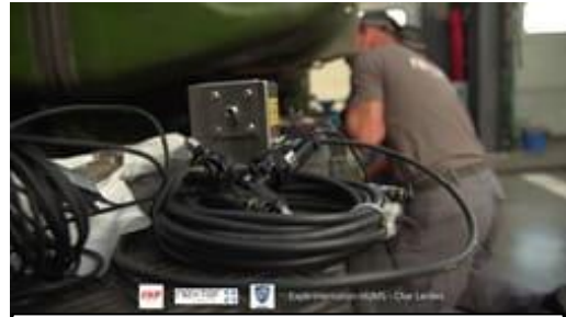
Le char a été équipé de six capteurs pour obtenir un jumeau numérique de son moteur. © CKP ENgineering
